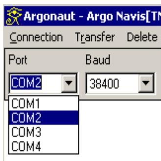
Vérifiez que le nombre de bauds réglé sur ARGONAUT™ est le même que celui d'ARGO NAVIS™. Cela demande de vous connecter au portCOM du PC en utilisant le menu déroulant de connexion –
